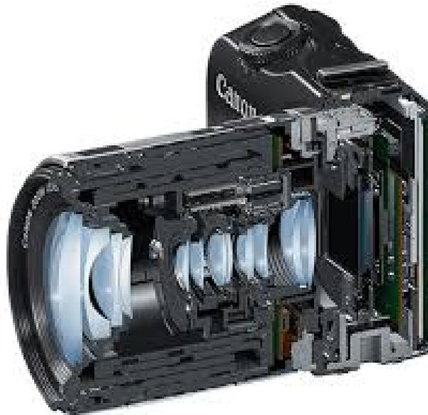
El pentaprismo se sustituye por una mini pantalla que realiza las funciones de visor óptico de la cámara.
