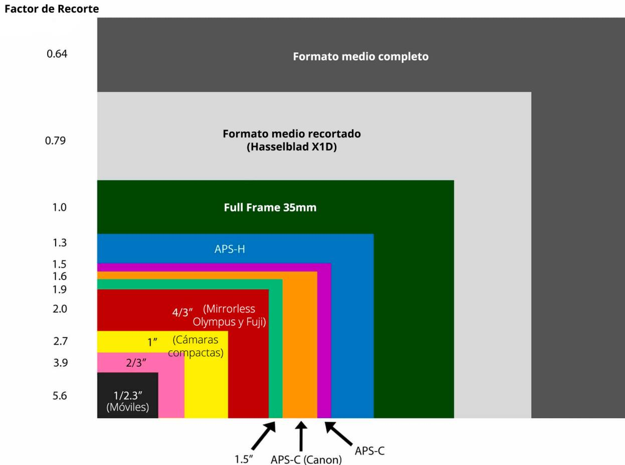
El tamaño del sensor tiene relación directa con la calidad de imagen. Los fotocaptadores de una cámara se reparten sobre ese sensor, y es lo que marca la resolución de una cámara (una cámara de 14 megapíxeles contiene 14 millones de fotocaptadores integrados en el sensor). Si el espacio es mayor, tendrán más espacio y podrán capturar mejor la luz.
